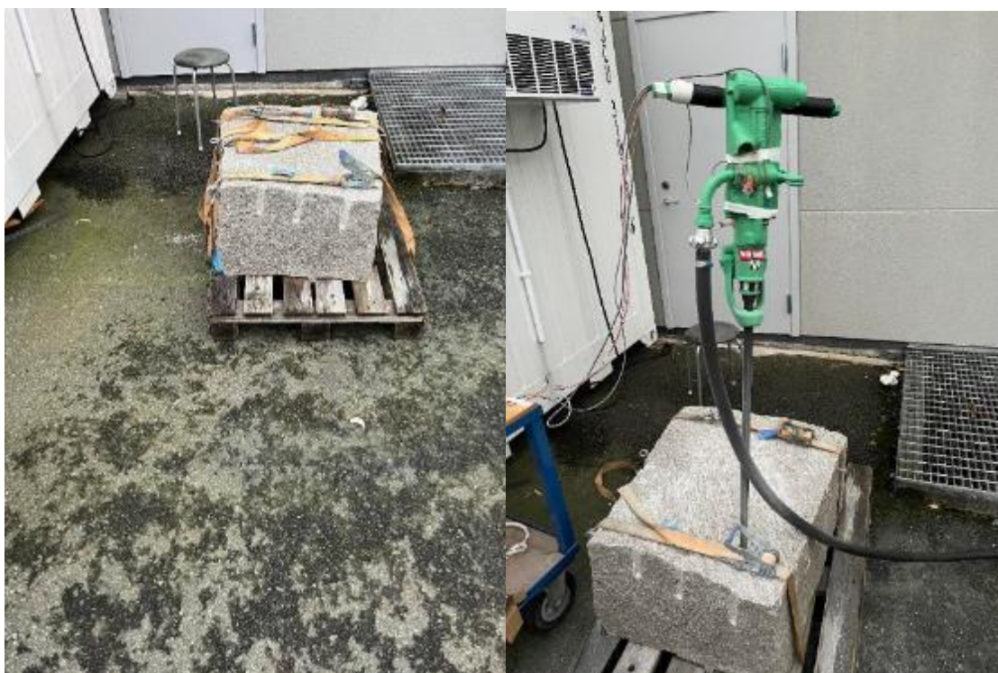
Figur 3.10 och 3.11: 3.10 visar stenblocket som användes vid test och 3.11 hur riggingen såg ut med borren och dess placering vid testen.
