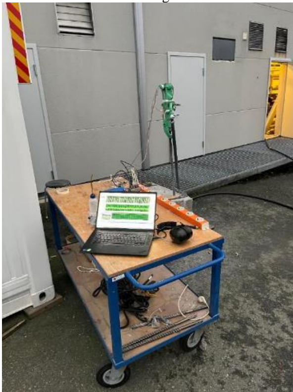
Figur 4.2: Setup för borring i sten med mätdator.
