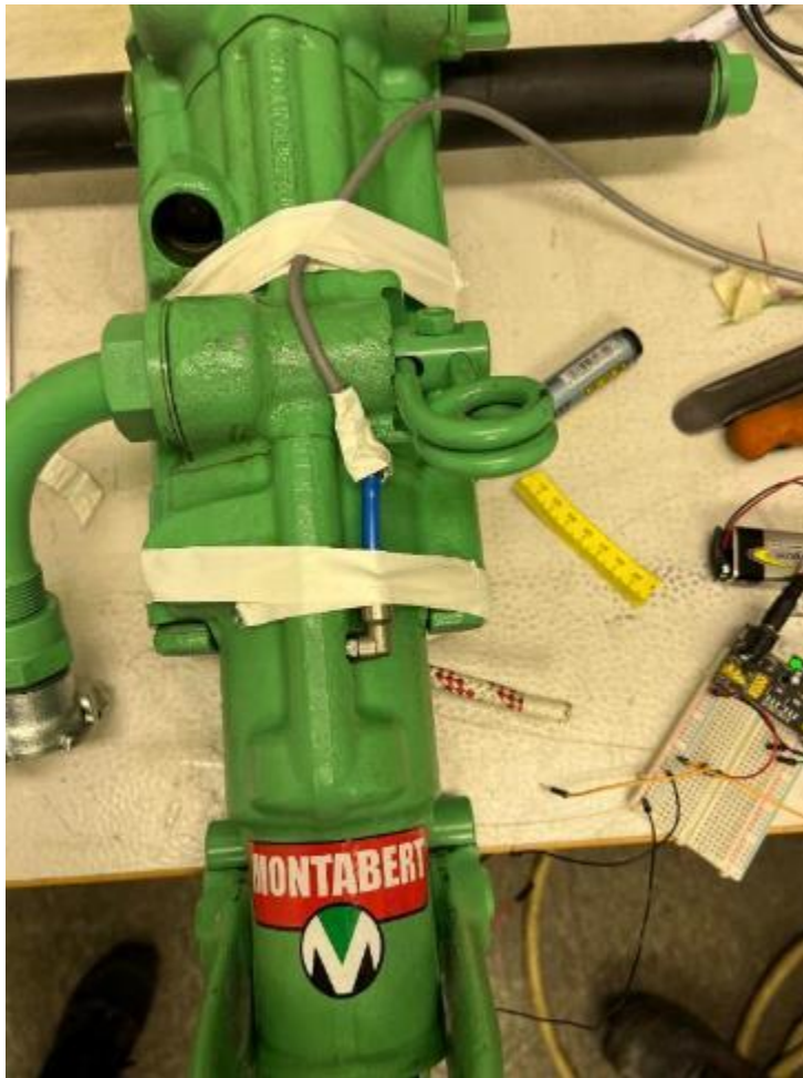
Figur 3.9: Trycksensorn [12] kopplades in med en slang till ett borrar hål där luftflödet färdas mot borrar toppen (närmast utflödet som möjligt).
