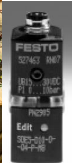
Figur 3.9: Trycksensorn [12] kopplades in med en slang till ett borrar hål där luftflödet färdas mot borrar toppen (närmast utflödet som möjligt).
