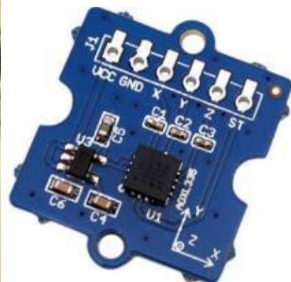
Figur 3.8: Accelerometern [8] flyttades ut till handtaget för att utöver för rörelserna också bli känsligare för det vridmoment som uppstår när borsten fastnar och därav ge större värdeändring. I samtliga bilder med accelerometern är x vinkelrät mot handtaget med riktning bakåt mot den som håller i maskinen för körning, y är i linje med handtagen höger till vänster och z är i borrarlinjen neråtgående riktning.
